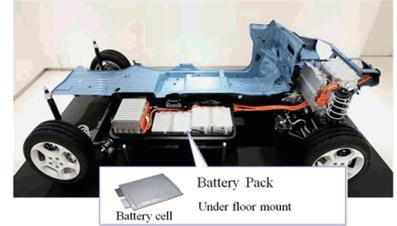
車載用リチウムイオン電池とEVの構造図
